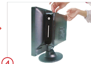
Sujete el gabinete Mini ITX a su monitor
