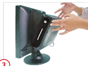
Coloque el gabinete Mini ITX en un ángulo de 45°
